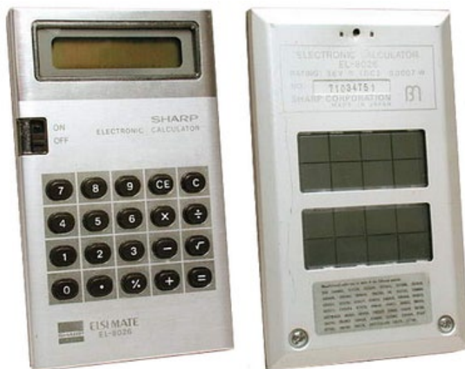
Calculatrice solaire avec les cellules photovoltaïques au dos.
